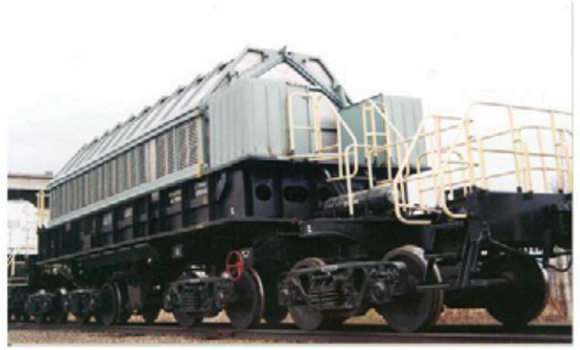
Железнодорожный транспортер для перевозки ОЯТ реакторов ВВЭР-1000
