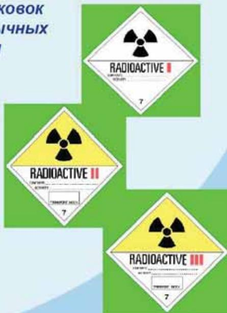
Рис. 3. Категории радиационной опасности грузов РМ (табл.5.4. НП-053-04) [5].
