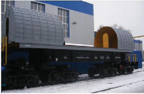
Железнодорожный транспортер для перевозки ОЯТ реакторов РБМК-1000
